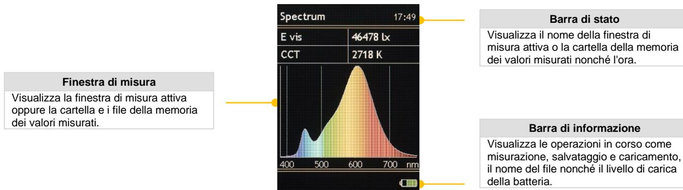
Il simbolo della batteria nella barra di informazione segnala il livello di carica della batteria oppure il funzionamento con alimentatore o alimentazione da PC. Il LED di ricarica segnala, anche con lo strumento spento, se la ricarica è in corso o se la batteria è già completamente carica.
