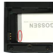
Mettre en place l'accumulateur
