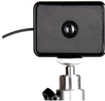
Das Gerät hat eine optische Messsonde mit Lichtwellenleiter und einen Adapter für das Minispektrometer mit Kodierung für das automatische Laden der Kalibrierdatei. Die Messsonde kann bei Distanzmessung auf einem Stativ installiert werden. Alternativ dazu kann sie bei Aufsatzmessung mit einem Gegengewicht direkt vor das Display gehängt werden.
