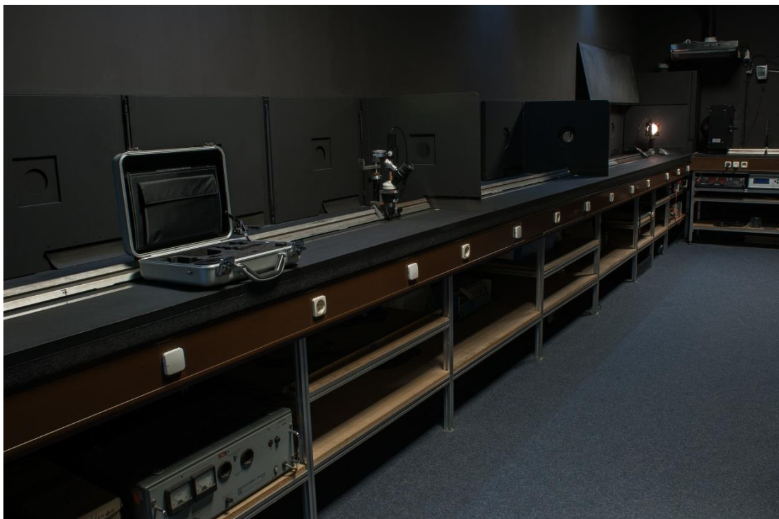
GOSSEN Lichtlabor – Optische Bank für die Kalibrierung von Beleuchtungsstärke und Leuchtdichte
